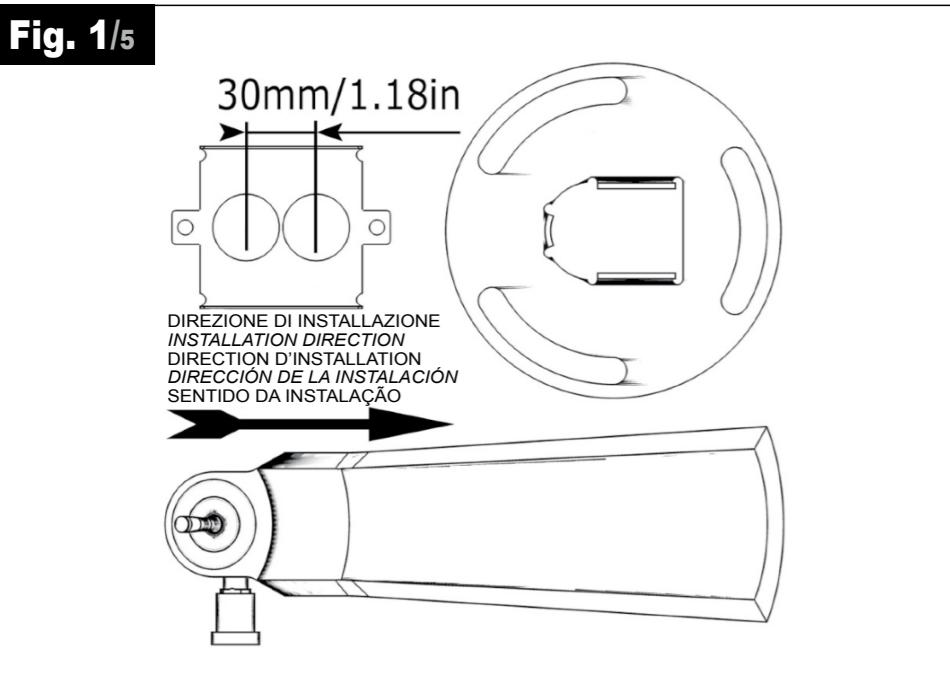
**IT** Prima di incassare la ditta **2-A** verificare la corretta direzione, come indicato in **Fig 1**. Per un incasso ottimale predisporre gli attacchi con interasse di 30 mm (1.18in).
