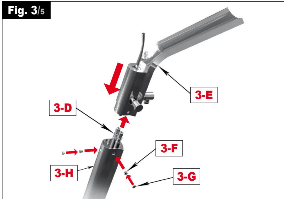
**IT** Avvitare i flessibili **3-D** al corpo miscelatore **3-E** quindi inserirli all'interno del tubo colonna **3-H**. Innestare il corpo miscelatore **3-E** nel tubo colonna **3-H** e fissarli tramite le viti **3-F**. Coprire le viti **3-F** con il tappini **3-G**.
